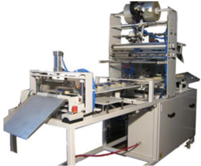
Este equipo es capaz de envasar productos de variadas medidas con un rango de 80 hasta 320 mm de ancho, con solo cambiar el conformador, (consultar medidas especiales).
